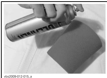
vbs2009-012-015_a TYPIQUE - VAPORISER DU NETTOYEUR DE CHAQUE CÔTÉ DE L'ÉLÉMENT
