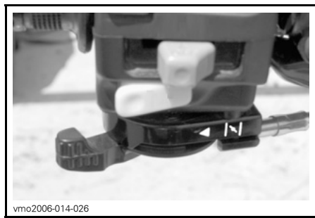
ESTRANGULADOR DE AIRE TOTALMENTE ABIERTO
