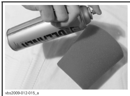
TYPBILD - SPREJA SKUMFILTERDELEN PÅ INSIDAN OCH UTSIDAN
