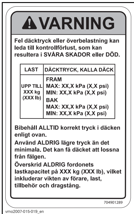
DEKAL 5 (OBSERVERA: SE SPECIFIKATIONSTABELLEN FÖR EXAKT DÄCKTRYCK)
