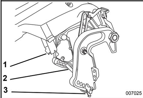
1. Bügel für die Flachwasserantriebsstellung
