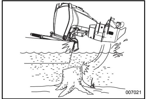
**HINWEIS** Das Stoßdämpfersystem des Außenborders funktioniert nicht im Rückwärtsgang. Wenn Sie rückwärts gegen ein Objekt fahren - entweder im Wasser oder beim Transport - können Boot und Außenborder schwer beschädigt werden.
