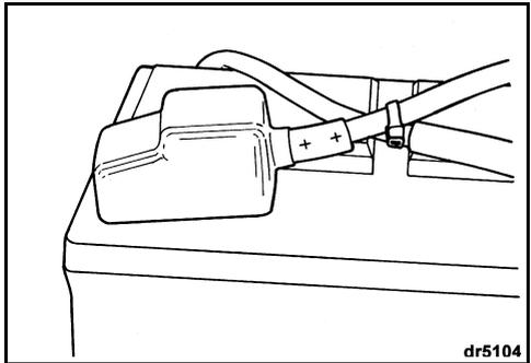
**HINWEIS** Verwenden Sie **KEINE** Flügelmuttern an den Batterieanschlüssen, selbst wenn sie der Batterie beiliegen. Flügelmuttern können sich lösen und falsche Warnsignale oder Schäden an der elektrischen Anlage verursachen.
