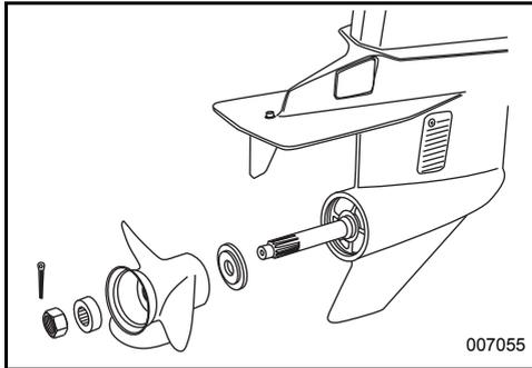
Klemmen Sie einen Holzklötz zwischen Schraubenblatt und Belüftungsschutzplatte.
