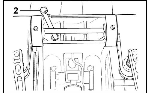
1. Tornillo de fricción del acelerador
