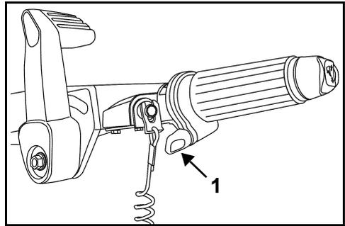
1. Tornillo de fricción del acelerador
