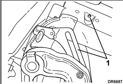
1. Puntos de lubricación de la palanca de inclinación, el eje de palanca y el soporte giratorio (anualmente)
