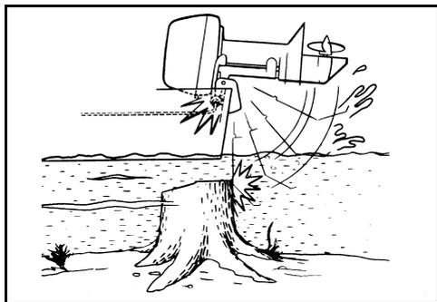
**AVISO** O sistema de amortecedor de choques do motor de popa não funciona em marcha a ré. Caso ocorra um choque contra um objeto, seja na água ou durante o reboque, o barco e o motor de popa poderão ficar seriamente danificados.
