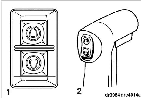
1. Interruptor de inclinação para reboque
