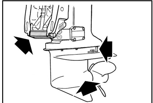
A corrosão galvânica destrói as peças metálicas submersas e pode ocorrer em água doce ou salgada; no entanto, as águas salgadas, salobras ou poluídas acelerarão a corrosão.
