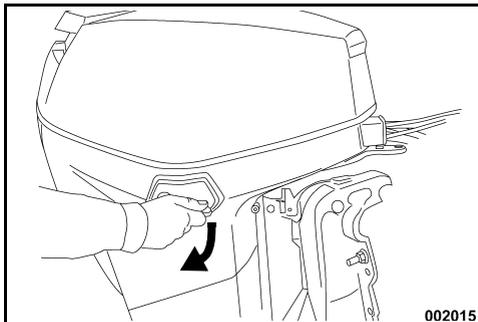
Puxe o cabo de inclinação para cima para soltar a vedação da tampa do motor.
