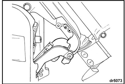
**Lösen der Halterung** — Kippen Sie den Außenborder vollständig. Klappen Sie die Transporthalterung wieder nach oben in ihre Verstaungsposition. Senken Sie den Außenborder, bis er seine senkrechte Position erreicht hat.
