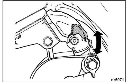
Wenn Sie das Kippen des Außenbordermotors abgeschlossen haben, rasten Sie den Kipperrhebel aus:
