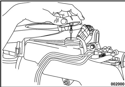
Setzen Sie den Tankdeckel wieder auf, und schließen Sie ihn sorgfältig. Installieren Sie die Abdeckung wieder.
