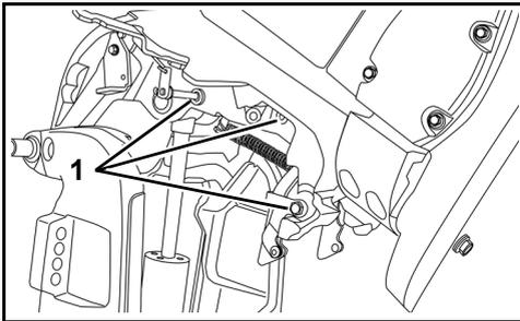
1. Modelle mit manueller Kippvorrichtung, Schmierstellen an Kippbügeln (jährlich)
