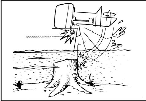
**HINWEIS** Das Stoßdämpfersystem des Außenborders funktioniert nicht im Rückwärtsgang. Wenn Sie rückwärts gegen ein Objekt fahren - entweder im Wasser oder beim Transport - können Boot und Außenborder schwer beschädigt werden.
