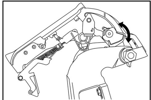
Wenn Sie das Kippen des Außenbordermotors abgeschlossen haben, rasten Sie den Kipperrhebel aus:
