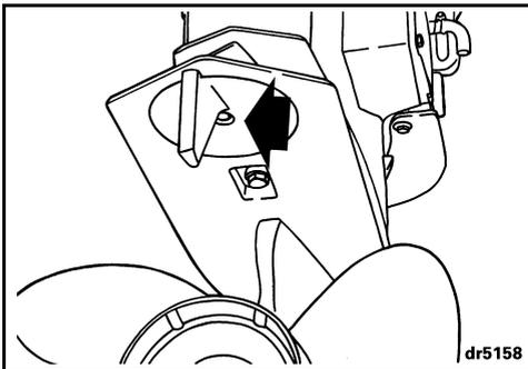
Die Trimmflossenschraube mit einem Drehmoment von 47 - 54 N•m anziehen.
