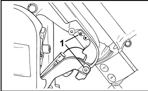
1. Modelle mit Trimm- und Kippautomatik, Schmierstellen an Transporthalterung und Kippbügeln (jährlich)
