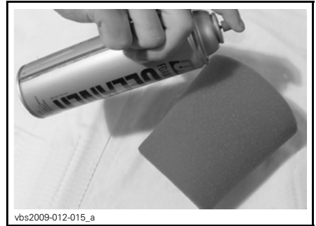
TYPISCH - SCHAUMSTOFFFILTERELEMENT BESPRÜHEN
