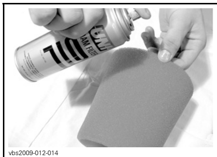
TYPISCH - SCHAUMSTOFFFILTERELEMENT ÖLEN
