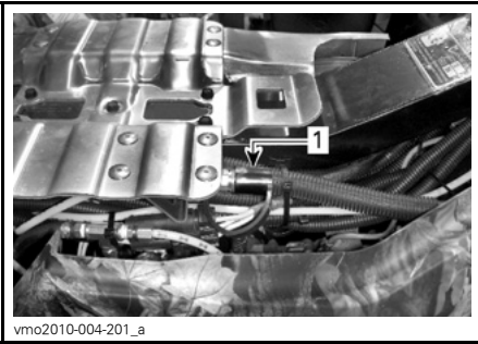
1. Anschlussstück des Kompressors
