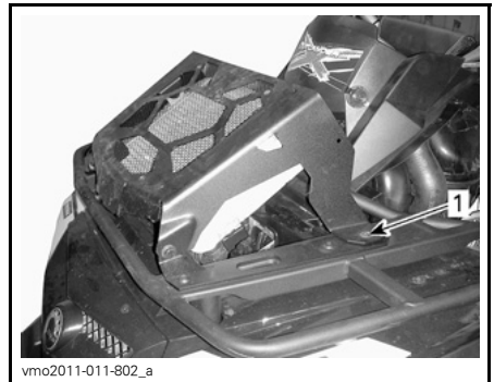
1. Lage der Befestigungsschraube
