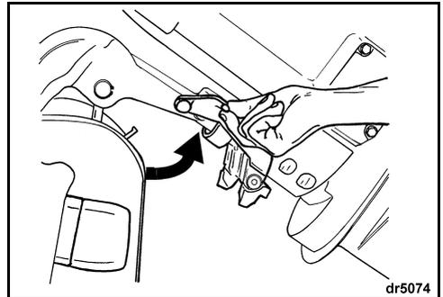
El fueraborda ha sido diseñado para ser transportado en posición vertical o inclinado, con ayuda del soporte para remolcado. Utilice la posición más adecuada para la embarcación.
