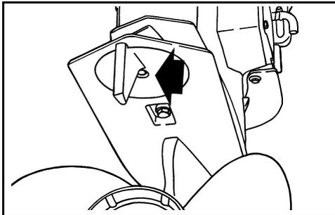
Apriete el tornillo de la aleta estabilizadora a un par de apriete de 47 a 54 N•m.
