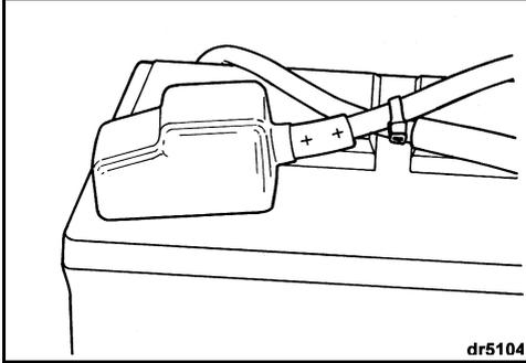
**IMPORTANTE:** NO use tuercas de mariposa para las conexiones de la batería, aunque se incluyesen con ésta. Las tuercas de mariposa pueden aflojarse y causar señales de advertencia indebidas o daños en el sistema eléctrico.
