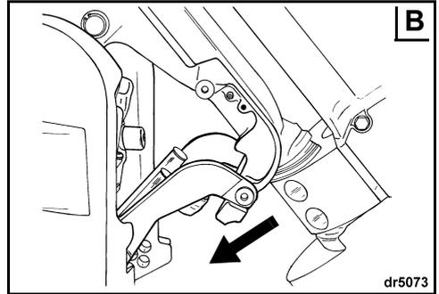
**Para desenganchar el soporte** — Incline el motor fueraborda completamente hacia arriba. Vuelva a colocar el soporte para remolcado en su posición de almacenamiento. Baje el fueraborda a la posición vertical.
