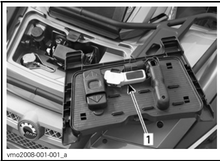
TYPISCH — VORDERES ZUGANGSELEMENT 1. Winden-Fernsteuerung
