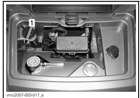
TYPISCH - VORDERES SERVICEFACH 1. Anschluss für Fernsteuerung
