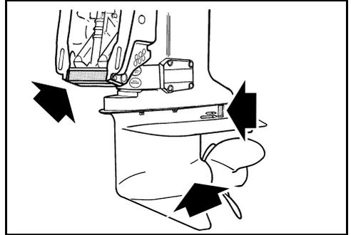
Galvanische Korrosion zerstört Metallteile unter Wasser und kann in Süß- oder Salzwasser auftreten. In Salz-, Brack- und Schmutzwasser wird die Korrosion allerdings beschleunigt.
