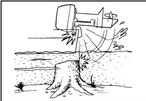
Das Stoßdämpfersystem des Außenborders funktioniert nicht im Rückwärtsgang. Wenn Sie rückwärts gegen ein Objekt fahren - entweder im Wasser oder beim Transport - können Boot und Außenborder schwer beschädigt werden.
