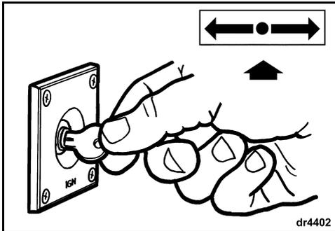
**WICHTIG:** Der Startermotor kann beschädigt werden, wenn er **ohne Unterbrechung** mehr als 20 Sekunden lang betätigt wird.
