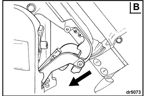
**Lösen der Halterung** — Kippen Sie den Außenborder vollständig. Klappen Sie die Transporthalterung wieder nach oben in ihre Verstaunungsposition. Senken Sie den Außenborder, bis er seine senkrechte Position erreicht hat.
