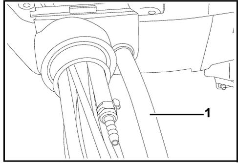
1. Kraftstoffschlauch - 9 mm
