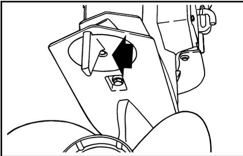
Ziehen Sie die Trimmflossenschraube mit einem Anzugsdrehmoment von 47 – 54 N·m fest.
