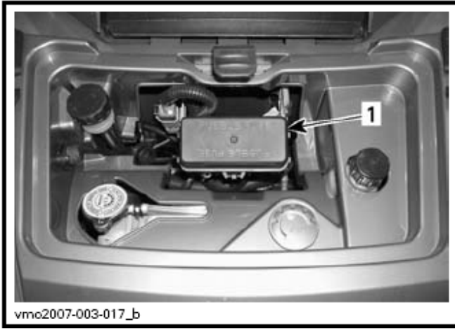
典型图示 – 前面检修盖板
