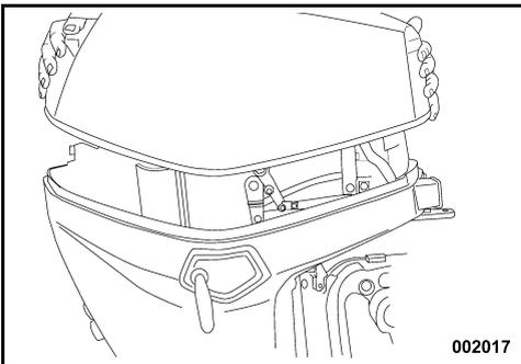
Remova a tampa do bocal de abastecimento e abasteça o tanque com o lubrificante recomendado para o motor de
