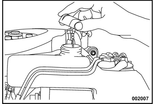
Recoloque a tampa do bocal de abastecimento e aperte-a bem. Reinstale a tampa do motor.
