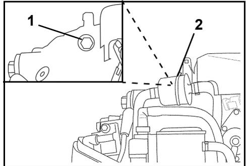
1. Wasserdruckanschluss (hinter Kraftstofffilter)
