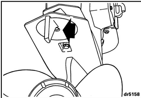
Ziehen Sie die Trimmflossenschraube mit einem Drehmoment von 47–54 N·m an. Machen Sie eine Testfahrt, und wiederholen Sie den Vorgang nach Bedarf, bis der Kraftaufwand beim Lenken möglichst gleichmäßig ist.
