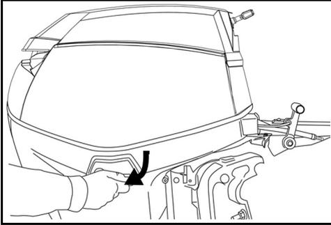
Ziehen Sie den Kippgriff nach oben, um die Dichtung der Motorabdeckung zu entriegeln.
