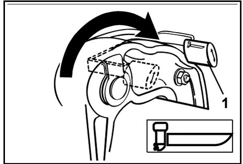
Ergreifen Sie den Kippgriff auf der Motorabdeckung, und heben Sie den Außenborder leicht an. Die Kippstütze entriegelt automatisch.
