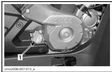
MOOTTORIN OIKEA PUOLI 1. Mittatikku
