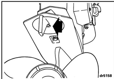
Serrare la vite dell'aletta di correzione assetto con una coppia compresa fra 47 e 54 N m.
