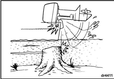
**AVVISO** Il sistema di ammortizzamento del fuoribordo non funziona in retromarcia. In caso di urto in acqua o durante il traino, il fuoribordo e l'imbarcazione possono danneggiarsi seriamente.
