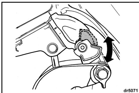
Una volta inclinato il fuoribordo, disinnestare la leva di blocco inclinazione:
