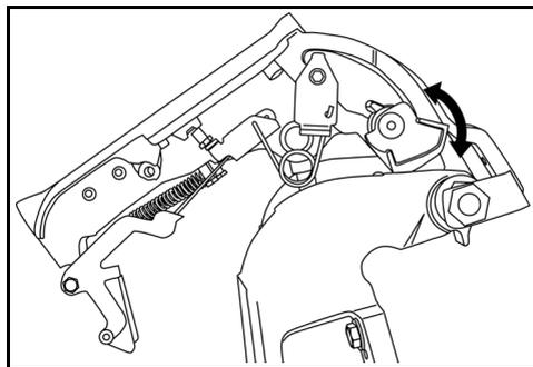
Una volta inclinato il fuoribordo, disinnestare la leva di blocco inclinazione:
