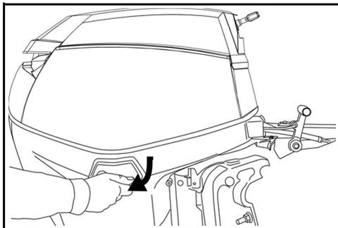
Tirare verso l'alto l'impugnatura di inclinazione per sbloccare la tenuta della copertura del motore.
