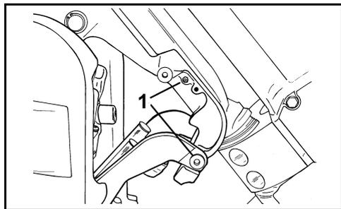
1. Modelli con assetto e inclinazione servoassistite, punti di lubrificazione staffa di traino e staffa del supporto girevole (annuale)
