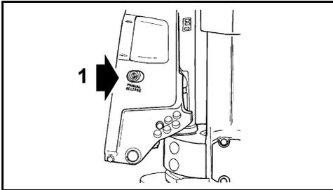
1. Dispositivo di sbloccaggio manuale
