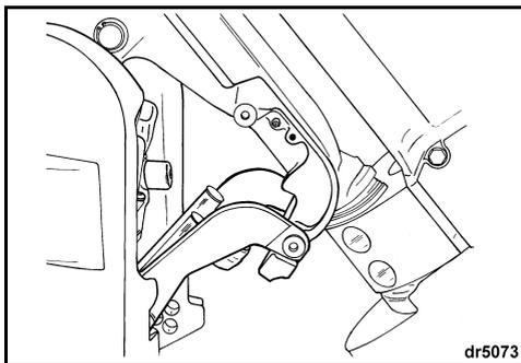
**Per disinserire la staffa** — Inclinare completamente il fuoribordo. Riportare la staffa di traino in posizione di stivaggio. Abbassare il fuoribordo in posizione verticale.
