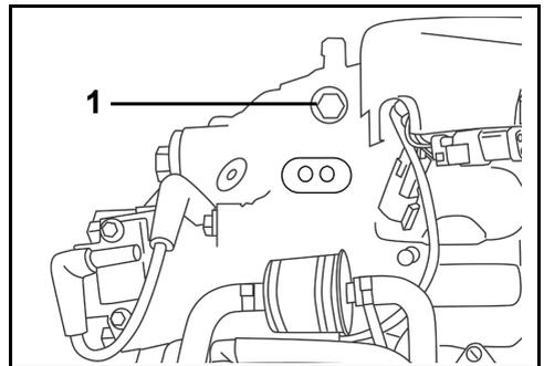
1. Presa per controllo della pressione dell'acqua (lato di dritta)
