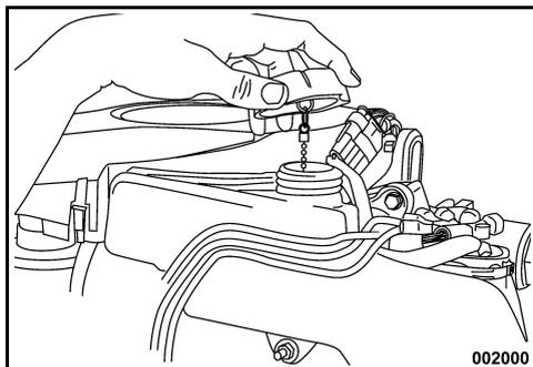
Reinserire il tappo del serbatoio e serrare saldamente. Ripristinare la copertura del motore.
