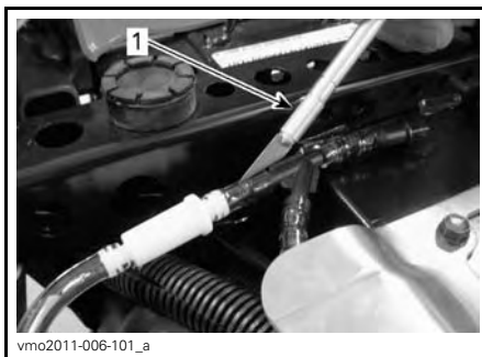
ESIMERKKI - LEIKKAA VAROVASTI LETKU
