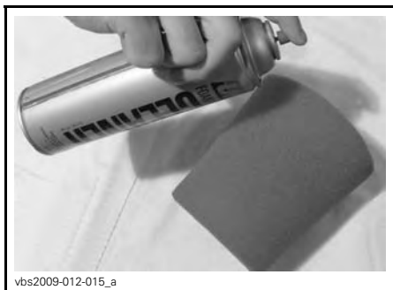
TYYPILLINEN - SUIHKUTA VAAHTOMUOVIPANOS SISÄ- JA ULKOPUOLELTA
