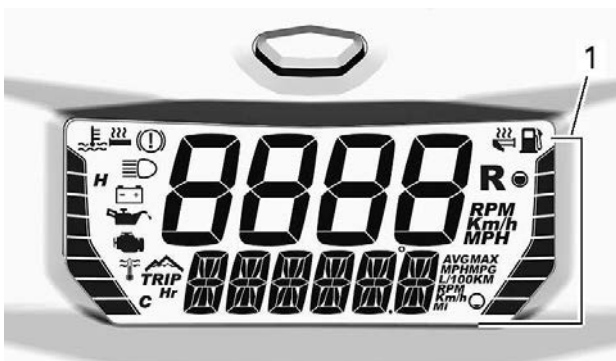
1. Søylemåler høyre side
