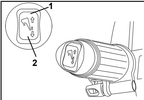
1. Interruptor de elevación/inclinación
