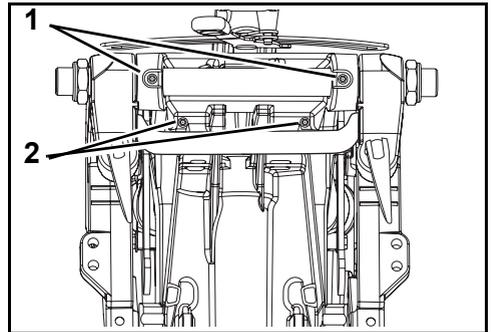
1. Puntos de lubricación del tubo de inclinación (anualmente) 007033
