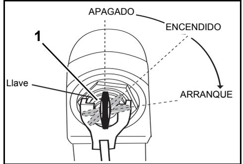
1. Contacto, posición de apagado (OFF)
