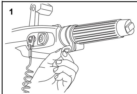
1. Tornillo de fricción del acelerador 007041
