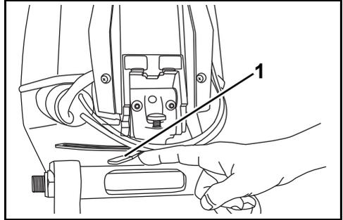
1. Palanca de fricción de la dirección 007042
