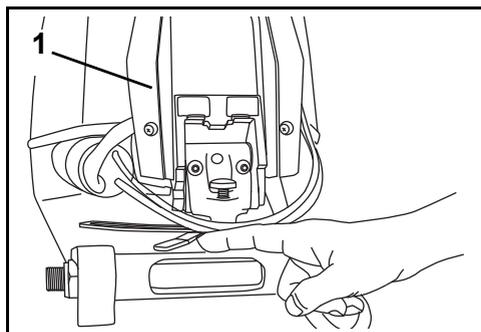
1. Palanca de fricción de la dirección 007042
