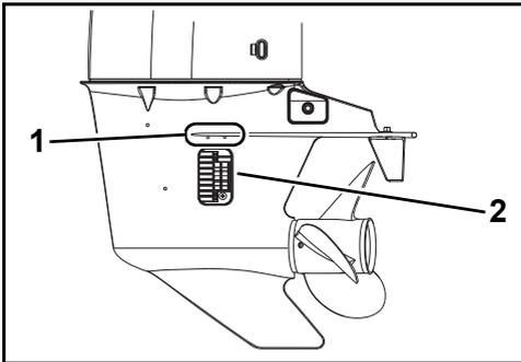
1. Orificios auxiliares de entrada de agua 007035
