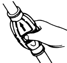
Lato serbatoio carburante
