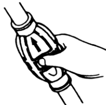
Lado del depósito de combustible
