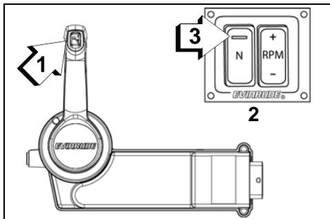
*ICON II*-Steuerung für verdeckten seitlichen Einbau
