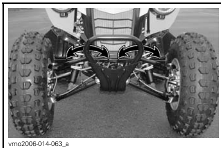
PARE-CHOC AVANT — POINTS D'ARRIMAGE DES SANGLES
