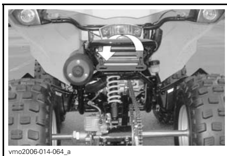
PARE-CHOC ARRIÈRE — POINT D'ARRIMAGE DES SANGLES
