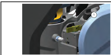
1. Valvola di scarico manuale dello sterzo, posizione aperta: modelli a barra con sterzo assistito
