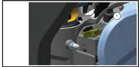
1. Offen-Position, manuelles Entlastungsventil für die Pinne mit Servolenkung
