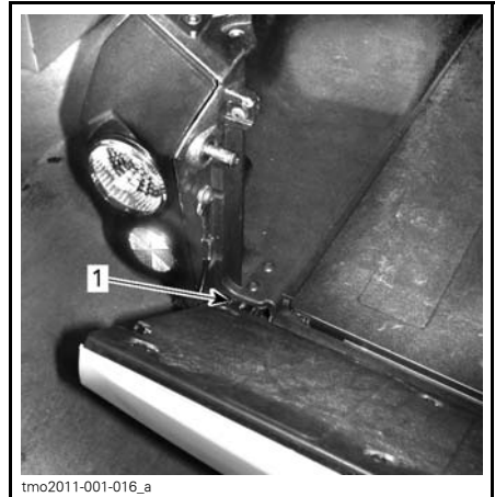
1. Gelenk der oberen Ladeklappe
