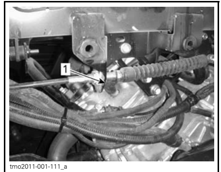
LINKS — VORDERER ZYLINDER 1. Zündkerze
