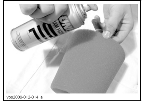
TYPISCH - ÖLEN SIE DAS SCHAUMFILTERELEMENT
