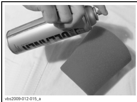
vbs2009-012-015_a TYPISCH - BESPRÜHEN SIE DAS SCHAUMELEMENT VON INNEN UND AUßEN
