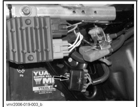
TYPISCH HINTERER SICHERUNGSHALTER
