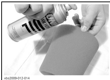
TYPISCH - FILTERELEMENT MET OLIE SMEREN
