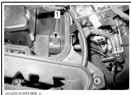
1. Filtre à air du compresseur ACS
