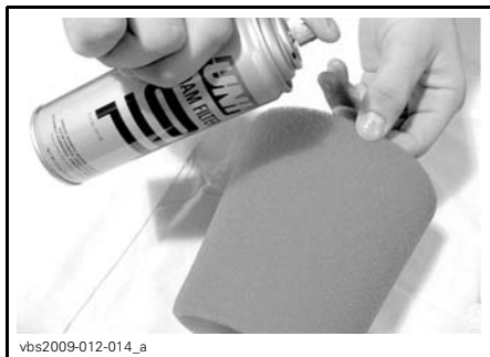
TYPIQUE - HUILER L'ÉLÉMENT EN MOUSSE
