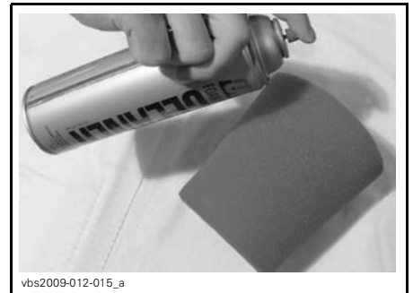
vbs2009-012-015_a TYPIQUE - IMPRÉGNER L'ÉLÉMENT EN MOUSSE
