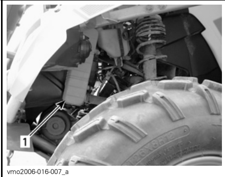
SITUAZIONE TIPICA 1. Radiatore
