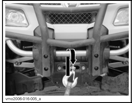
TÍPICO - LOCAL DE FIXAÇÃO DIANTEIRA
