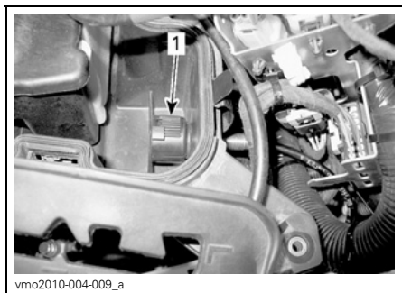
1. Filtro de ar do compressor ACS
