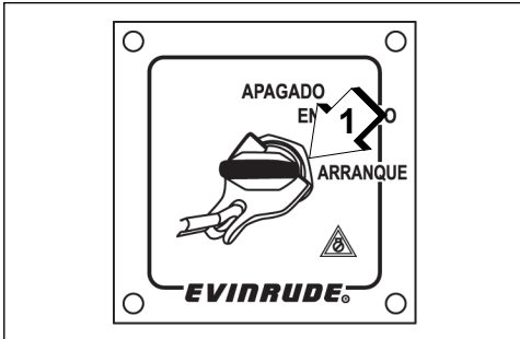
1. Contacto, posición de ARRANQUE 009048
