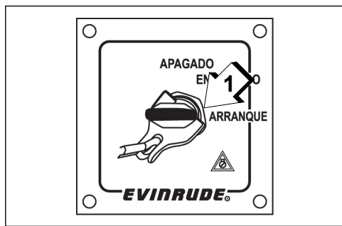
1. Contacto, posición de ARRANQUE 009048
