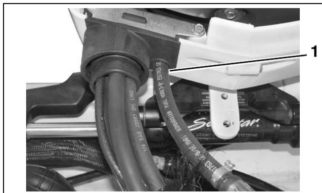
1. Emplacement de substitution du flexible de carburant 004946
