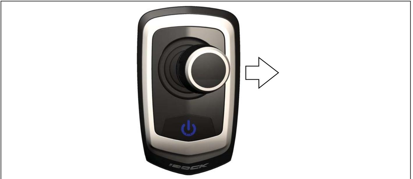
Cuando se empuje el joystick a estribor, el motor de babor proporcionará empuje de retroceso, y el motor de estribor aplicará empuje de avance para que la embarcación se dirija a estribor.
