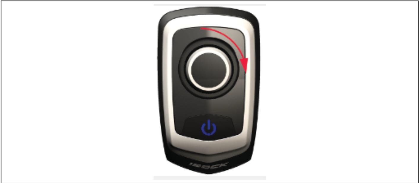
Cuando se gire el joystick en sentido horario, el motor de babor proporcionará empuje de avance, y el motor de estribor aplicará empuje de retroceso para que la embarcación vire a estribor.
