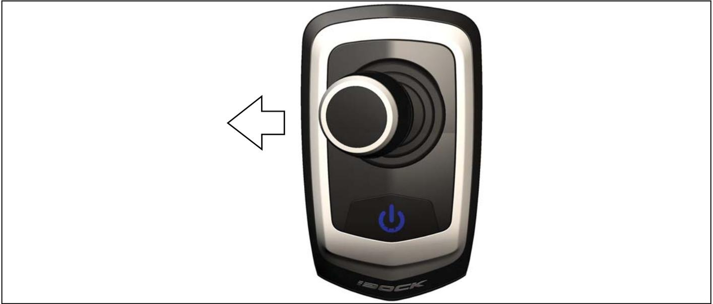
Cuando se empuje el joystick a babor, el motor de babor proporcionará empuje de avance, y el motor de estribor aplicará empuje de retroceso para que la embarcación se dirija a babor.
