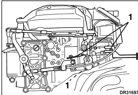
1. Starter, axe et dispositif de blocage de levier de sens de marche
