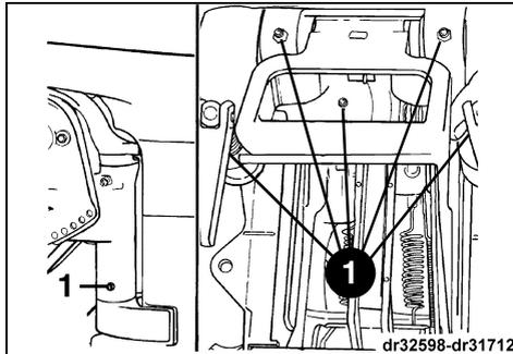
1. Support pivotant, vis de fixation, axe de levier de relevage/marche et arbre de relevage
