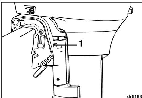
1. Vis de réglage de friction de direction
