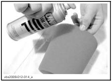
TYPICAL - OIL THE FOAM FILTER ELEMENT
