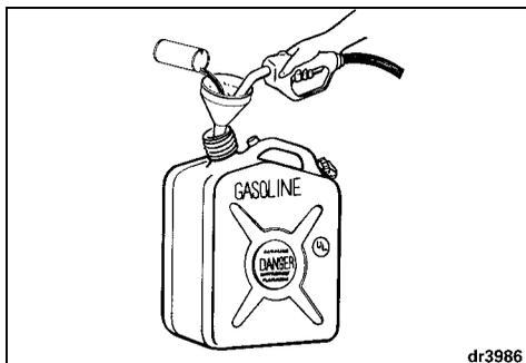
Verser le mélange de carburant dans le réservoir intégré au moteur. Remettre le bouchon du réservoir de carburant en place et fermer son évent jusqu'à ce que le moteur soit monté sur le bateau et prêt à fonctionner.
