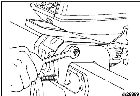
**IMPORTANT** : NE PAS trop serrer. Cela augmente la pression nécessaire pour relever le moteur en cas de heurt d'un obstacle. Le moteur risque d'être gravement endommagé s'il ne se relève pas en cas de heurt.
