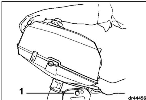
1. Axe de verrouillage de relevage
