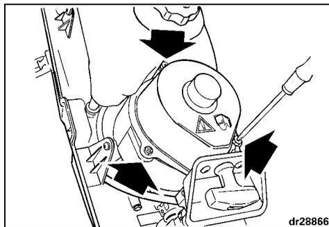
Faire un nœud à l'extrémité du cordon de démarreur de secours et l'accrocher dans l'encoche du volant-moteur. Enrouler le cordon en le tournant dans le sens des aiguilles d'une montre autour du bord de démarreur du volant-moteur.
