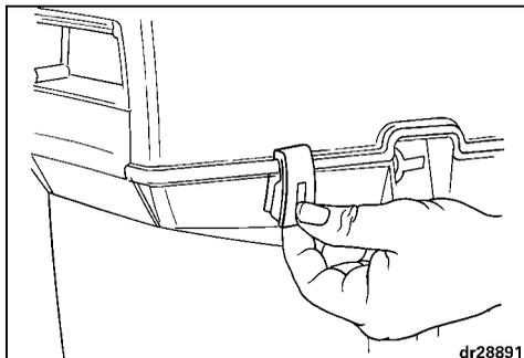
Desserrer les deux vis du carter de démarreur et celle de fixation du réservoir de carburant. Déposer le carter de démarreur.
