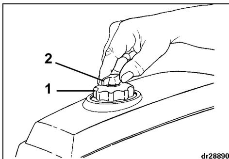
1. Bouchon de réservoir de carburant
