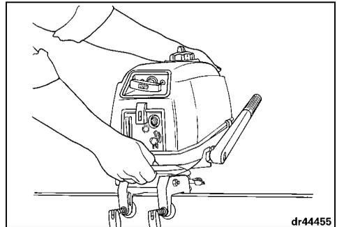
Le cas échéant, serrer les vis de fixation avec les doigts, PAS à l'aide d'un outil.
