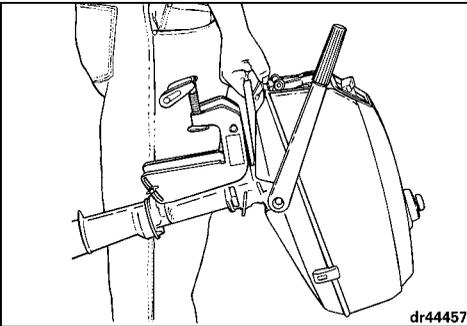
Lors du transport, coucher le moteur sur le côté où se trouve le bouton de la soupape de coupure de carburant.
