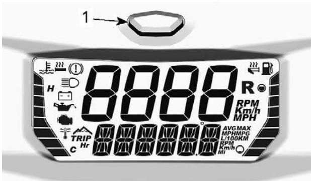
1. Modus-Taste des Anzeigeinstruments
