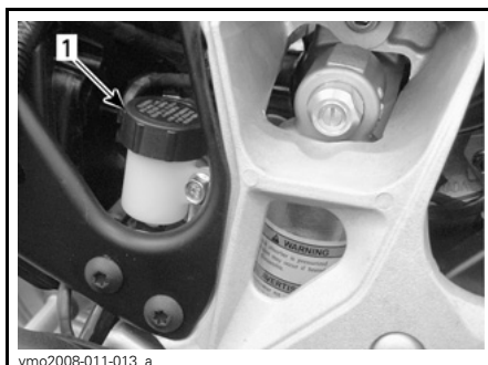
vmo2008-011-013_a SITUADO AL LADO DEL GUARDABARROS TRASERO DERECHO 1. Depósito de líquido de los frenos traseros
