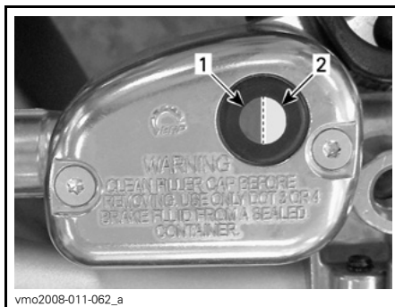
vmo2008-011-062_a TÍPICO 1. Nivel de líquido correcto 2. Nivel de líquido bajo
