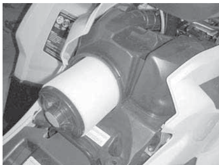
AUSBAU DES LUFTFILTERS
