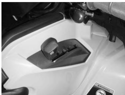
РАСПОЛОЖЕНИЕ РЫЧАГА ПЕРЕКЛЮЧЕНИЯ ПЕРЕДАЧ
