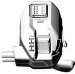
РЕЖИМ 2WD - ТИПИЧНЫЙ ВАРИАНТ
