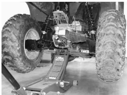
TYPIQUE — POINT DE LEVAGE ARRIÈRE
