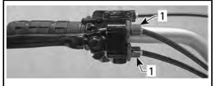
1. Регулировочные винты на рычаге тормоза
