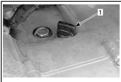
ПРОБКА ЗАЛИВНОГО ОТВЕРСТИЯ — ЛЕВАЯ СТОРОНА ДВИГАТЕЛЯ
