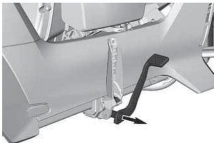
4. Abbassare il poggiapiedi e verificare che il guidatore possa premere completamente il pedale del freno.
