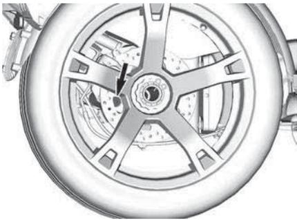
1. Girare la ruota posteriore finché è possibile accedere al tappo di riempimento attraverso un'apertura del freno a disco.
