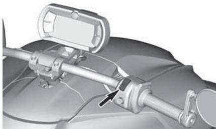
Per avviare il motore, impostare l'interruttore arresto motore sulla posizione RUN.
