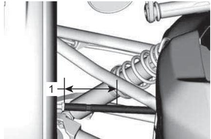
1. Zugstange in diesem Bereich fassen
