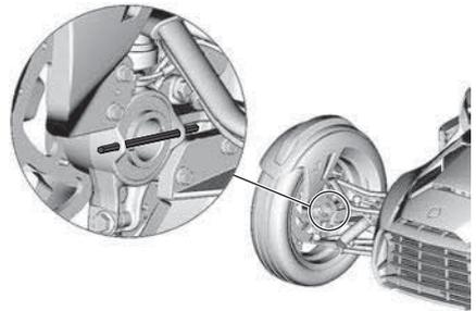
4. Entfernen Sie den roten Sicherungsclip.
