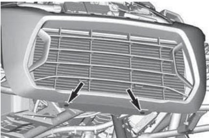
4. Rollen Sie das Ende der Frontverkleidungserweiterungen, um die hinteren Befestigungen zu lösen.
