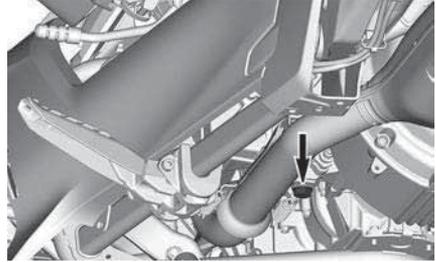
4. Stellen Sie eine Ablaufwanne unter den Bereich des magnetischen Ablaufstopfens des Getriebes.
