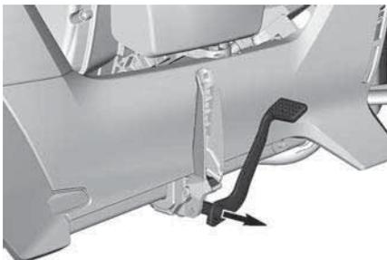
4. Senken Sie den Fußrasten und stellen Sie sicher, dass der Fahrer den vollen Anschlag des Bremspedals ausführen kann.
