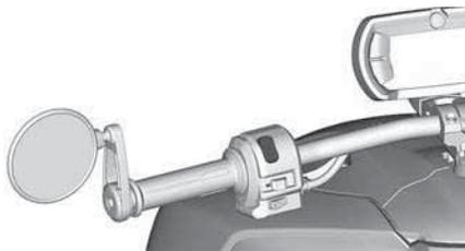
Dieser Schalter wird zum Wechseln zwischen Fern- und Abblendlicht verwendet.
