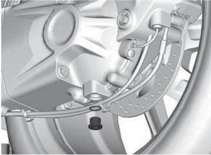
5. Entfernen Sie den Einfüllstopfen.
