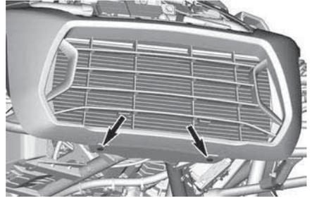
5. Ziehen Sie die Schrauben unter der Frontverkleidung gemäß Vorgabe an.
