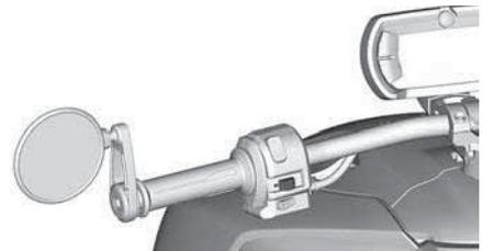
Er schaltet sich nach einem normalen Richtungswechsel selbst aus. Allerdings muss er nach einem geringfügigen Richtungswechsel oder nach einem Fahrspurwechsel manuell ausgeschaltet werden.
