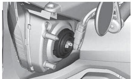
4. Drehen Sie den Glühbirnenstopper entgegen dem Uhrzeigersinn, um ihn zu lösen.
