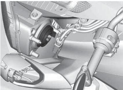
4. Drehen Sie den Glühbirnenstopper entgegen dem Uhrzeigersinn, um ihn zu lösen.
