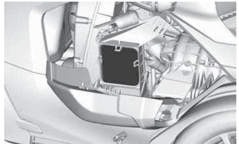
1. Entfernen Sie die Schraube, mit der die Unterseite des CVT-Luftfiltergehäuses befestigt ist.
