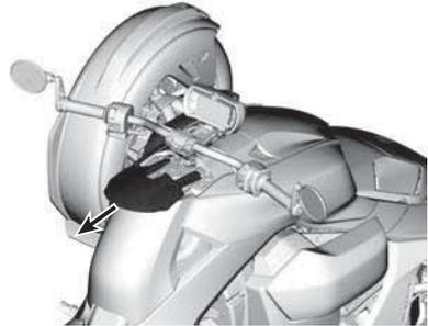
4. Schrauben Sie die Kraftstoffbehälterkappe zum Entfernen gegen den Uhrzeigersinn ab.
