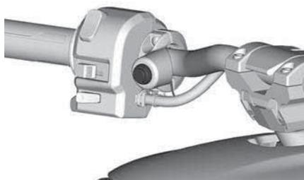
Die Geschwindigkeitsregelung erlaubt Ihnen, eine konstante Geschwindigkeit während der Fahrt beizubehalten. Die Geschwindigkeitsregelanlage passt dabei die Motordrehzahl an die
