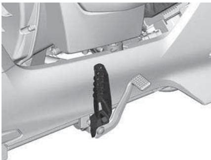
2. Schieben Sie den Fußrasten und das Bremspedal nach vorne oder hinten in die gewünschte Position.
