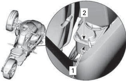
1. Markierung für min. Bremsflüssigkeitsstand
