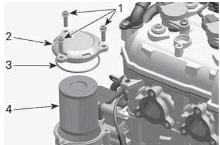
1. Schrauben der Ölfilterabdeckung
