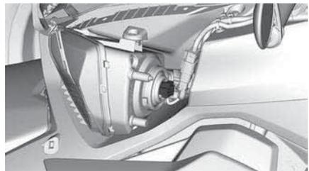
3. Entfernen Sie die Abdeckung der Scheinwerferlampen.
