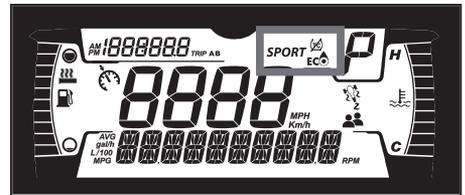
Auf der MODE-Anzeige wird der ausgewählte Fahrmodus angegeben:
