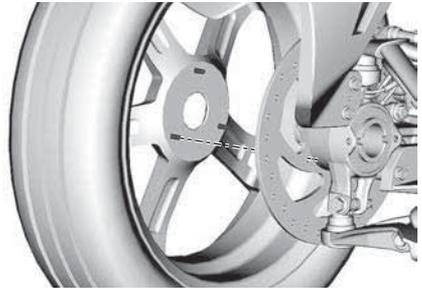
2. Bringen Sie die Kegelscheibe und die mittlere Radfeststellmutter an.
