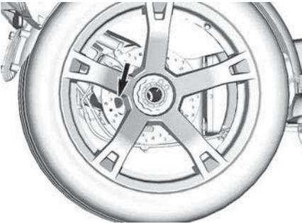
1. Drehen Sie das Hinterrad so weit, bis der Einfüllstutzen durch eine Scheibenbremsöffnung erreicht werden kann.
