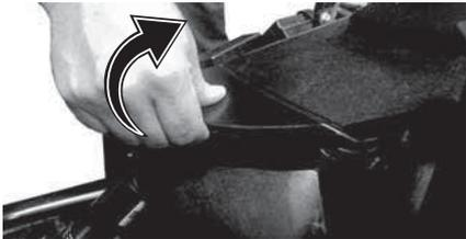
4. Drehen Sie die Schrauben unter der Frontverkleidung ein und ziehen Sie sie nur handfest an.
