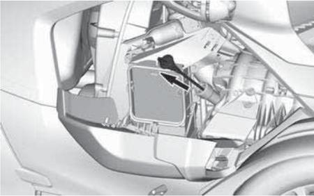
5. Reinigen Sie den Bereich um die Ablassschraube herum.
