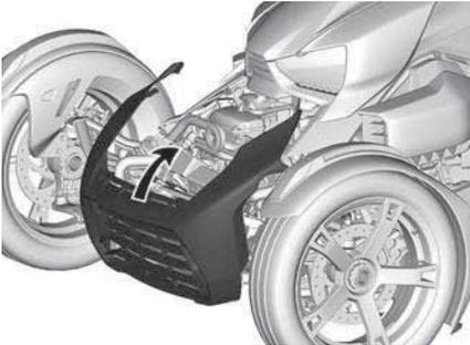
3. Rollen Sie beide Enden der Frontverkleidungserweiterung nach oben.
