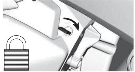
Den Schlüssel entgegen dem Uhrzeigersinn drehen, um den Parkpositionshebel zu entsperren.
