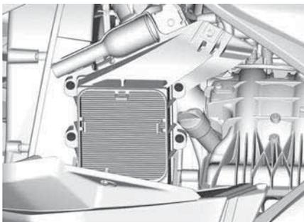
4. Entfernen Sie den Luftfilter aus dem Gehäuse.
