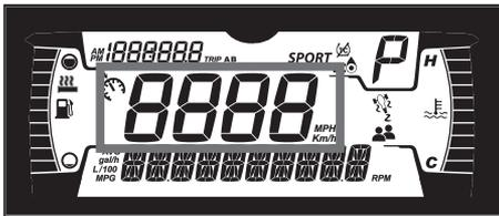
Anzeige der Fahrzeuggeschwindigkeit in km/h oder mph.
