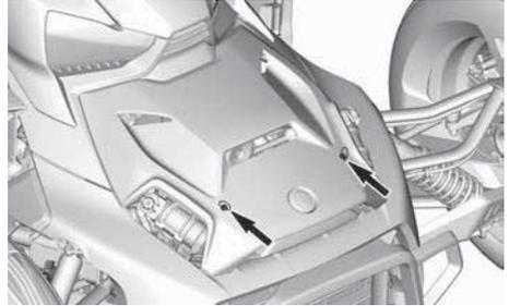
2. Heben Sie die vordere Abdeckun-gen und schieben Sie sie nach vorn.
