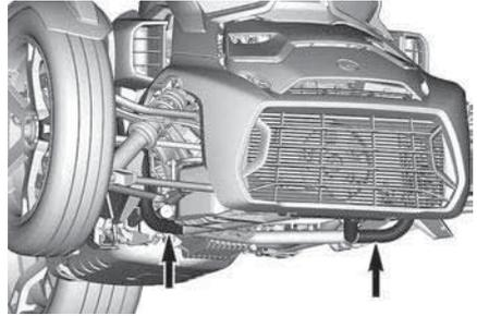
**HEBEN SIE DEN VORDEREN TEIL DES FAHRZEUGS MIT DIESEN ROHREN AN ODER STÜTZEN SIE IHN AB.**
