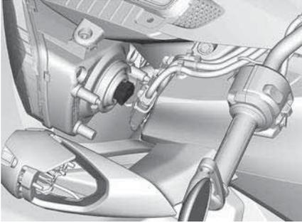
3. Entfernen Sie die Abdeckung der Scheinwerferlampen.
