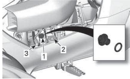
**LAGE DER GETRIEBEÖLEINFÜLLSCHRAUBE DER**
