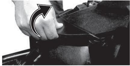
5. Ziehen Sie die Frontverkleidung nach vorne, um sie vom Fahrzeug zu lösen.
