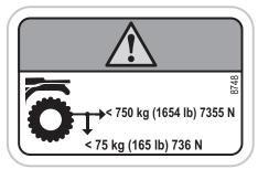
LOCATED ON THE TRAILER HITCH (IF EQUIPPED)
