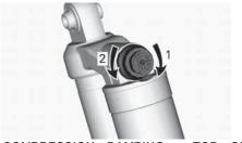
COMPRESSION DAMPING - TOP OF SHOCK ABSORBER
