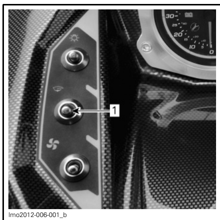
1. Interruptor de la bomba de achique
