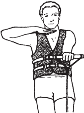
PARAR EL MOTOR - Pasar el dedo a todo el ancho de la garganta.
