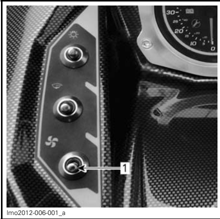
1. Bilge blower switch
