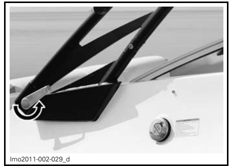
TRIBORD - TOURNER LA POIGNÉE DE 3/4 DE TOUR DANS LE SENS ANTIHORAIRE À LA POSITION VERROUILLÉE
