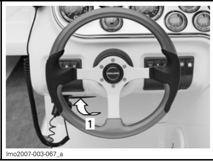
1. Ubicación del panel de disyuntores
